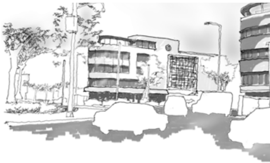
Figura 13 Edificios Moritz y Narvarte, Ciudad de México. La envolvente continua y otros elementos de orden tipológico: su imagen 'naviera', el uso de bandas horizontales, parteluces y losas ligeras para destacar el roof garden en la azotea. Boceto de los autores.
