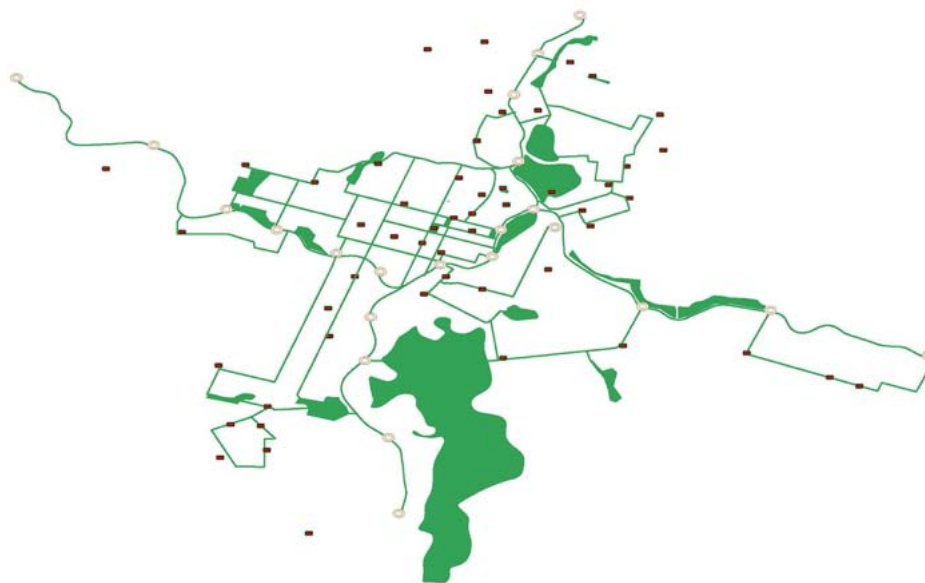
Figura 13. Mapa da rede de transportes ativos. As linhas verdes representam as rotas cicloviáveis; as massas verdes representam praças, parques, fundos de vale e áreas de preservação; os elementos circulares indicam estações do VLT e os elementos retangulares indicam as estações de aluguel de bicicletas.
